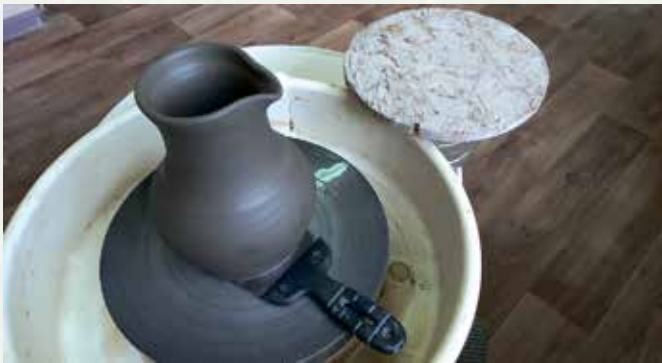
7. После того, как изделие срезано, его с помощью шпателя снимают с гончарного круга.
