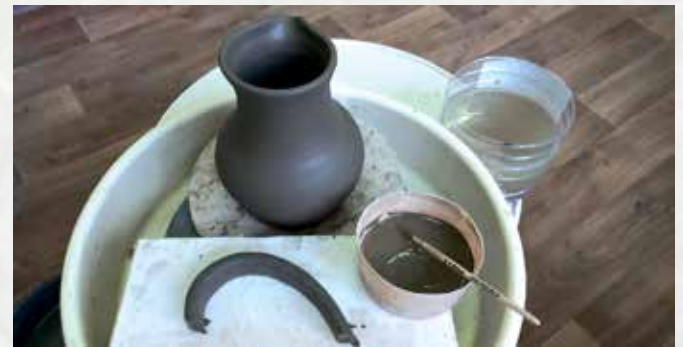
10. После того, как полоска задуманной ширины и длины будет сделана, ее плавно изгибают в виде скобы.
