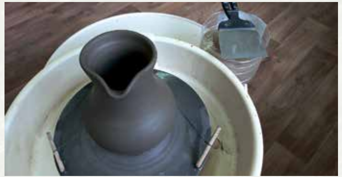
6. После того, как изделие примет задуманную форму, промином и сжатием кромки горлышка проминается носик, и изделие срезается у дна натянутой струной.
