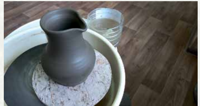
8. Снятое изделие ставят на деревянную лещетку или материал, поглощающий влагу.
