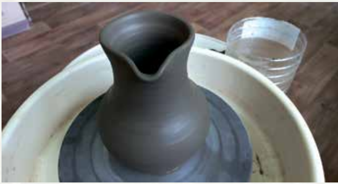
5. После раздутия стакана приступают к изготовлению горлышка путем сдавливания и сужения верхней части сосуда.
