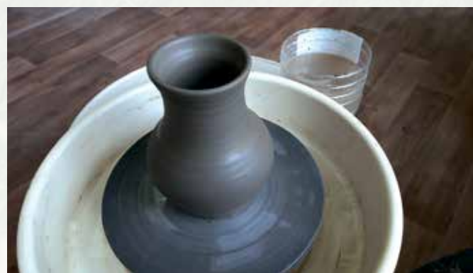
4. Затем, надавливая изнутри, стакан расширяют примерно до середины, если кувшин будет с узким горлышком, и – выше, если кувшин должен быть с широким.
