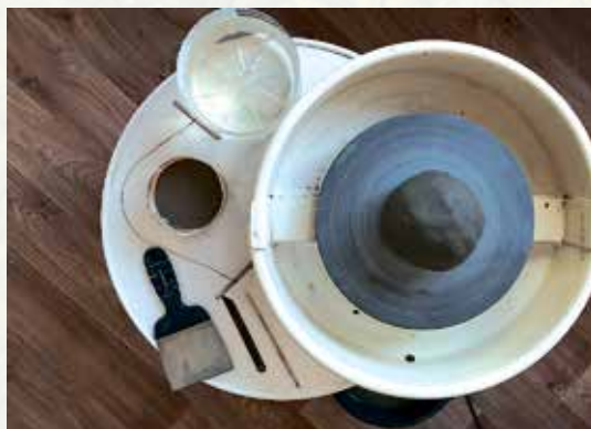
1. Для изготовления кувшина нужны гончарный круг, глина, вода, шпатель, струна для срезания и снятия изделия с гончарного круга.
